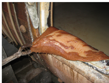
Extraction des peaux du foulon après bain d'épilage. Tannerie Garat & Fils. Armendaritz.
